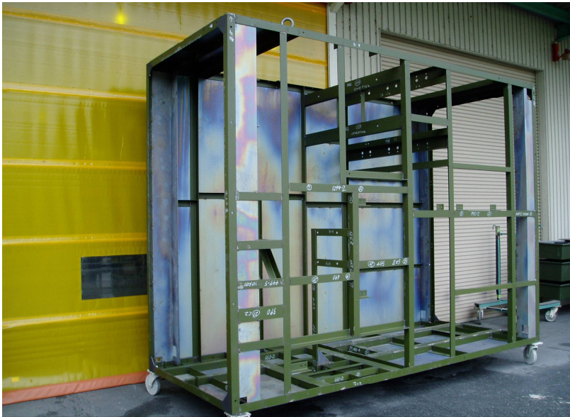
脱脂兼リン酸鉄皮膜処理工程後 シャワー式塗装前処理設備、サプロテック KSP 使用 製品寸法 ( mm ) W1600 × D4000 × H2900
