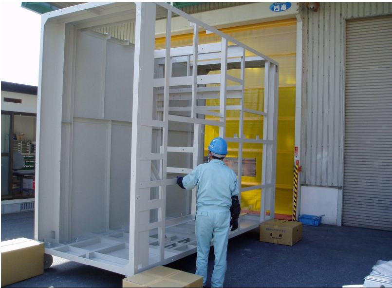
塗装上塗り完了後 粉体塗装 1コート
